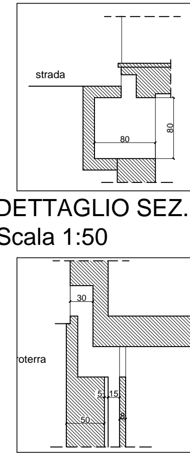
DETTAGLIO SEZ. K:K Scala 1:50
